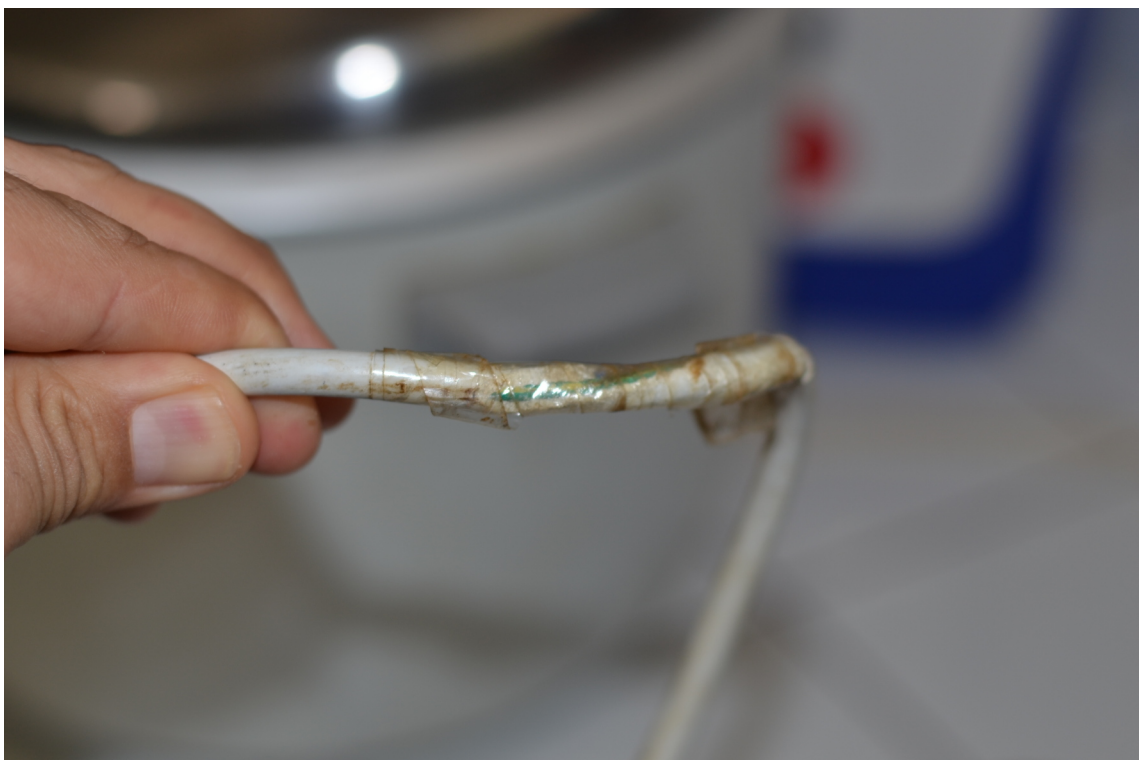
fil du batteur mélangeur dénudé
