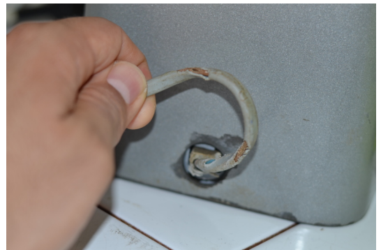
fil du batteur mélangeur dénudé
